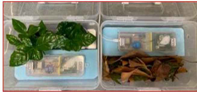
<測定> 透明のBOX内にCO2測定器と観葉植物
